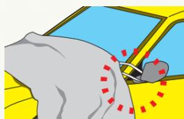
左右のドアミラーを倒した状態にし、着脱アシストゴムをひっかけます。
