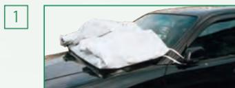
1 カバー裏面にフロントタグが付いている方が前部になりますのでフロントタグをボンネットの前部に置くようにおきます。
